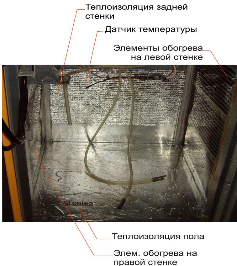
Рис.2 Кофейный автомат ROSSO. Монтаж элементов обогрева.
